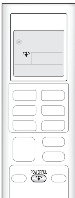
La operación POTENTE maximiza rápidamente el efecto de refrigeración (calefacción) en cualquier modo operativo. En este modo, el aire acondicionado opera a la máxima capacidad.
