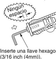
No aplique aceite de lubricación (aceite refrigerante) sobre el tapón de drenaje al introducirlo. La aplicación del aceite de lubricación al tapón de drenaje deteriorará el tapón, lo que ocasionará fugas de drenaje por el tapón.
