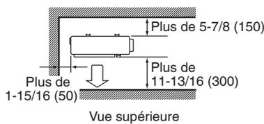
Lorsqu'il est installé comme sur la figure de gauche, il est recommandé soit de modifier son orientation du côté de la sortie de l'unité extérieure soit d'utiliser la grille de réglage de la direction de l'air (vendue séparément).
